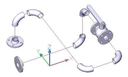
Dieses einfache Beispiel einer Rohrleitungskonstruktion ist fast fertiggestellt. Sie müssen den Rohrleitungsverlauf nur noch durch 2 Vorschweißflansche (Symbol spiegeln) und Rohrleitungen komplettieren. Dazu genügt die einfache Anwahl der Isometrielinien. Sie wählen entsprechend Symbolwahl – Rohrleitungen. Die Isometrielinien zur Erzeugung der Rohrleitungen wurden bereits automatisch in der Länge angepasst. Eine Nachbearbeitung Ihrerseits ist dementsprechend nicht mehr erforderlich.
