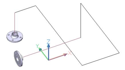
Damit hätten wir also die Enden Ihrer Rohrleitungskonstruktion fertig gestellt. Als nächstes vervollständigen wir die Rohrleitungskonstruktion weiter mit Rohrbogen. Hierzu ist nur die Wahl der entsprechenden Isometrielinien erforderlich.
