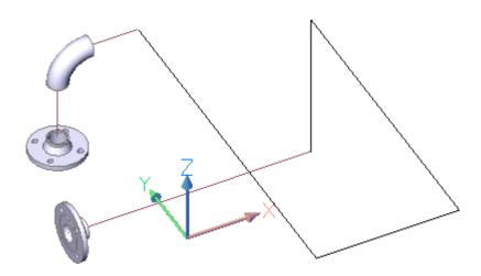
Alle benötigten Rohrbogen wurden von Ihnen erzeugt und die Isometrielinien entsprechend angepasst. Um den Rohrleitungsverlauf durch T-Stücke, Reduzierstücke oder z.B. Ventile zu erweitern siehe Benutzerhilfe, wo die Vorgehensweise detailliert erklärt wird. Ebenso das Einfügen und ausrichten von individuellen Rohrleitungsymbolen.
