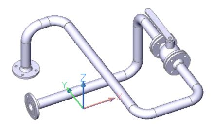
Damit wäre der Rohrverlauf endgültig fertig gestellt. Wir werden den Rohrverlauf noch nachträglich um ein T-Stück erweitern. Sie löschen die entsprechende Rohrleitung und erzeugen eine neue Isometrielinien zwischen den beiden Endpunkten, in diesem Beispiel zwischen Vorschweißflansch und Rohrbogen (Objektfang Zentrum Fang).
