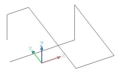
Beginnen wir mit der Erstellung von Vorschweißflanschen an den beiden Enden der 3D Rohrisometrie. Sie öffnen die Dialogbox Rohrleitungsymbole und wählen unter Optionen **Isometrielinien orientiert**. Danach unter Symbolwahl die Option Vorschweißflansch. Da die zu erzeugenden Flansche als Anschlußflansche für eine weiterführende Rohrleitungskonstruktion konzipiert werden sollen, wählen Sie zusätzlich die Option Symbol spiegeln.
