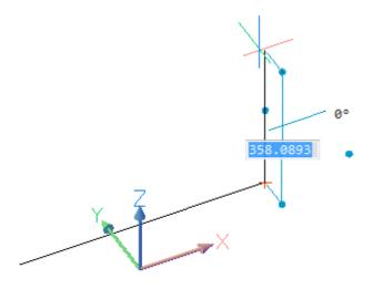
Sie generieren einen einfachen 3D Rohrverlauf. Ähnlich einer Rohrisometrie werden wir jetzt diesen Rohrverlauf mit 3D Symbolen ausfüllen.
