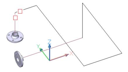
Die Rohrbogen passen sich automatisch dem Rohrverlauf an.
