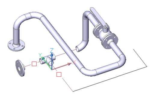
Das T-Stück wurde in den Rohrverlauf eingefügt. Sie erweitern die Rohrleitungskonstruktion wie bereits von Ihnen ausgeführt durch einen Vorschweißflansch, 2 Rohrbogen und die erforderlichen Rohrleitungen.
