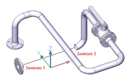
Die neu erzeugte Isometrielinie muß weitergeführt werden. Sie nutzen dazu wieder den BricsCAD Befehl *Linie* und setzen die erforderliche, weiterführende Linie(n) an.
