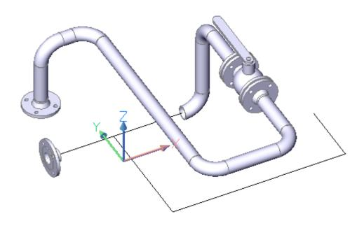
Jetzt kann das T-Stück eingefügt werden. Dazu ist die Anwahl der entsprechenden Isometrielinien erforderlich. Sie wählen entsprechend Symbolwahl – T-Stück.
