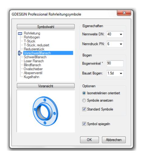
Sie bestimmen den Anschlußpunkt für den Vorschweißflansch, in diesem Beispiel die Enden der Isometrielinien und ebenfalls die weiterführende Richtung. Die Vorschweißflansche werden gemäß der gewählten Eigenschaften (Nennweite und Nenndruck) erzeugt und an den 3D Isometrielinien automatisch ausgerichtet. Die angewählten Isometrielinien werden angepasst (siehe Kennzeichnung Farbe).
